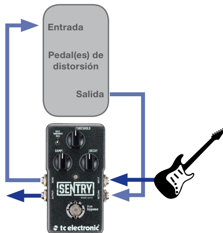
Pedales de efectos ruidosos colocados en la ruta de envío/retorno del Sentry Noise Gate
