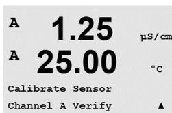
Entre en el modo de calibración, como se describe en el apartado 7.1 «Entrar en el modo de calibración», y seleccione «Verificar».
