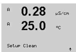
El intervalo de limpieza puede ajustarse de 0,000 a 999,9 horas. Si se ajusta a 0, se desactiva el ciclo de limpieza. El tiempo de limpieza puede estar entre 0 y 9999 segundos y debe ser inferior al intervalo de limpieza.
