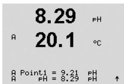
Coloque el electrodo en la primera solución amortiguadora. La pantalla muestra el tampón que ha reconocido el transmisor (punto 1) y el valor medido. Pulse [ENTER] para continuar.
