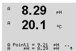
En cuanto se hayan cumplido los criterios de estabilización, la pantalla cambia. La pantalla muestra el factor «S» de calibración de pendiente y el factor «Z» de calibración de desviación.
