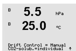
En aquellas bebidas para las que el usuario conozca los valores exactos de solubilidad del CO<sub>2</sub> y del factor de temperatura, estos se podrán modificar de forma individual. Si el usuario desea evaluar la solubilidad y los factores de temperatura, puede hacerlo mediante las fórmulas siguientes.
