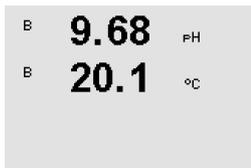
Después de determinar el valor de pH de la muestra, pulse la tecla [CAL] de nuevo para continuar con la calibración.
