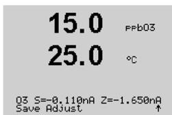
Después de la calibración, se visualizará la pendiente «S» y el valor de desviación «Z».
