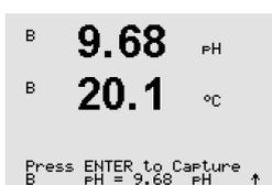
Obtenga una muestra y pulse la tecla [ENTER] de nuevo para guardar el valor de medición actual. «A» o «B» parpadea en la pantalla (en función del canal) y muestra el proceso de calibración en curso.
