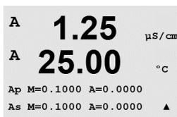
Se muestran todas las constantes de calibración para el canal de sensor seleccionado. Se muestran las constantes de medición primarias (p) en la línea 3. Las constantes de medición secundarias (s) (temperatura) para el sensor se muestran en la línea 4.
