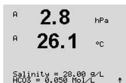
La **salinidad** describe la cantidad total de sales disueltas en el electrolito de CO<sub>2</sub> del sensor conectado al transmisor. Se trata de un parámetro específico del sensor. El valor predeterminado (28,00 g/l) es válido para el InPro 5000. No modifique este parámetro si piensa utilizar el InPro 5000.
