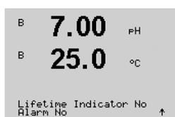
**Indicador del tiempo de vida útil:** la indicación dinámica del tiempo de vida útil permite efectuar un cálculo cuando el electrodo de pH o el cuerpo interior de un sensor amperométrico de oxígeno está al final de su vida útil, basado en la tensión real a la que está expuesto. El sensor toma permanentemente en consideración la tensión media de últimos días y puede incrementar/reducir el tiempo de vida útil de forma correspondiente.
