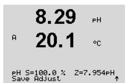
En los sensores ISM (digitales), seleccione Ajustar, Calibrar o Anular para terminar la calibración. En los sensores analógicos, seleccione Ajustar o Anular para terminar la calibración. Consulte el apartado 7.1.2 «Finalización de la calibración».
