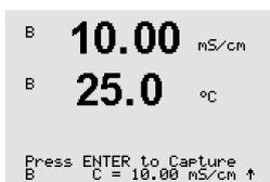
Obtenga una muestra y pulse la tecla [ENTER] de nuevo para guardar el valor de medición actual.
