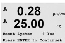
Pulse la tecla [ENTER] después de la selección para abrir la pantalla de confirmación. Si selecciona «No», regresará al modo de medición sin cambios. Si selecciona «Sí», se reiniciará el transmisor.
