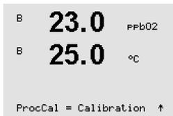
Seleccione «escalado» o «calibración» en el parámetro **ProcCal** para la calibración de proceso. Si se ha elegido «Scaling», la curva de calibración del sensor permanecerá intacta, pero la señal de salida del sensor se escalará. Si el valor de calibración es <1 %, la desviación de la señal de salida del sensor se modificará durante el escalado; si el valor es >1 %, se ajustará la pendiente de la señal del sensor. Para obtener más información sobre el escalado, consulte el manual del sensor.
