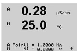
La primera línea de texto preguntará por el valor de resistencia del punto 1 (esto corresponderá al valor resistencia 1 mostrado en el accesorio del módulo de calibración). La segunda línea de texto mostrará el valor de resistencia medido. Cuando se haya estabilizado el valor, pulse [ENTER] para realizar la calibración.
