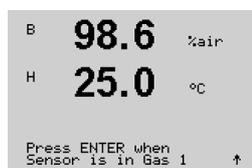
Coloque el sensor en el gas de calibración (p. ej. aire) o solución. Pulse [ENTER].
