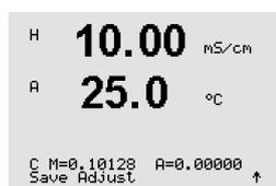
Después de la calibración, se visualizan el multiplicador o factor «M» de calibración de pendiente y el sumador o factor «A» de calibración de desviación.
