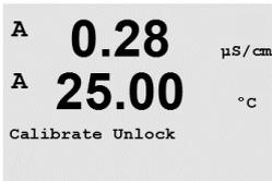
Seleccione este menú para configurar el menú «Cal». Para ello, consulte la sección 7 «Calibración del sensor».
