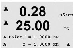
A continuación, la pantalla del transmisor solicitará al usuario que introduzca un valor para el punto 2 y mostrará el valor de medición de resistencia «T2». Cuando se estabilice este valor, pulse [ENTER] para realizar la calibración de este intervalo.
