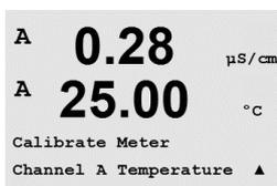
La primera línea de texto preguntará por el valor de resistencia de temperatura del punto 1 (esto corresponderá al valor de temperatura 1 mostrado en el accesorio del módulo de calibración). La segunda línea de texto mostrará el valor de resistencia medido. Cuando se haya estabilizado el valor, pulse [ENTER] para realizar la calibración.
