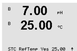
**STC RefTemp** define la temperatura a la que está referenciada la compensación de temperatura de la solución. El valor mostrado y la señal de salida toman como referencia la STC RefTemp. Si se selecciona «No», la compensación de temperatura de la solución no se utilizará. La temperatura de referencia más habitual es 25 °C. Pulse [ENTER].
