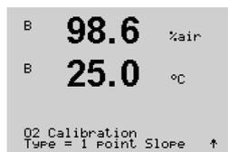
Seleccione «1 point» seguido de «Slope» o «ZeroPt» como tipo de calibración. Pulse [ENTER].
