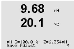
Después de la calibración, se visualizará el factor «S» de calibración de pendiente y el factor «Z».
