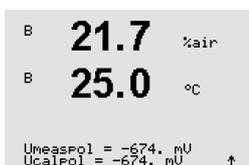
Si se ha conectado o configurado un sensor ISM existe la posibilidad de ajustar la tensión de polarización para el sensor. Puede introducir un valor diferente para el modo de medición (Umeaspol) y para el modo de calibración (Ucalpol). Para valores de 0 mV a -550 mV, el sensor conectado se configurará a una tensión de polarización de -500 mV. Si el valor introducido es inferior a -550 mV, el sensor conectado se configurará a una tensión de polarización de -674 mV.
