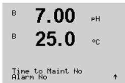
**Tiempo para el mantenimiento:** este temporizador estima cuándo debe realizarse el siguiente ciclo de limpieza para mantener el mejor rendimiento de medición posible. El temporizador se ve influenciado por cambios significativos en los parámetros DLI.
