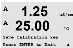
Seleccione Sí para guardar los valores de la nueva calibración, y en la pantalla se confirmará el éxito de la misma.
