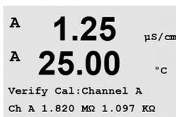
Se muestra la señal de las mediciones primaria y secundaria en las unidades eléctricas. Los factores de calibración del transmisor se utilizan para calcular estos valores.
