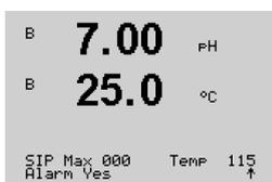
El límite del ciclo SIP cuenta el número de ciclos SIP. Si se alcanza el límite (definido por el usuario), se muestra una alarma en la pantalla. A través de la interfaz PROFIBUS PA puede conocer el límite del ciclo de autoclavización proporcionado por el bloque de entrada separada. La siguiente opción es posible:
