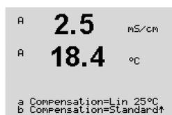
**La compensación lineal de 20 °C** ajusta la lectura según un coeficiente o factor expresado como «% por °C» (desviación desde 20 °C). Solo se debe utilizar si la solución tiene un coeficiente de temperatura lineal bien caracterizado.
