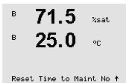
Si se conecta un sensor de pH o un sensor amperométrico de oxígeno, aparece el menú para reiniciar el tiempo para el mantenimiento. Debe reiniciar el tiempo para el mantenimiento después de las siguientes operaciones.
