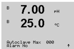
El límite de ciclo autoclave cuenta el número de ciclos de autoclavización. Si se alcanza el límite (definido por el usuario), se muestra una alarma en la pantalla. A través de la interfaz PROFIBUS PA puede conocer el límite del ciclo de autoclavización proporcionado por el bloque de entrada separada. La siguiente opción es posible:
