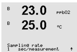
El intervalo de tiempo de un ciclo de medición del sensor a otro puede ajustarse, es decir, adaptarse a la aplicación. Un valor más elevado aumentará el tiempo de vida útil del OptoCap del sensor.
