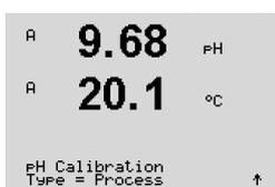
Seleccione «calibración de proceso». Con los sensores de pH, la calibración de proceso siempre se realiza como calibración de desviación.
