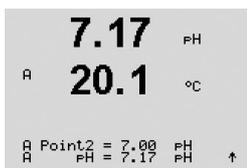
Coloque el transmisor en la segunda solución amortiguadora. La pantalla indicará el tampón que ha reconocido el transmisor (Punto 2) y el valor medido. Pulse [ENTER] para continuar.
