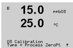
Seleccione «Proceso» y, a continuación, «Pendiente» o «Punto cero» como el tipo de calibración. Pulse [ENTER].
