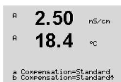
**La compensación Patrón** incluye la compensación de efectos de alta pureza no lineales, así como de impurezas de sal neutra convencionales, y cumple los estándares ASTM D1125 y D5391.
