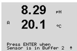
En cuanto se hayan cumplido los criterios de estabilización, la pantalla cambia y le indica que debe colocar el electrodo en el segundo tampón.
