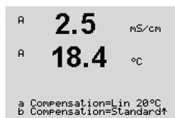
Si se selecciona el modo de compensación «Lin 25 °C» o «Lin 20 °C», es posible modificar el factor para el ajuste de la lectura después de pulsar [ENTER] (si trabaja en la línea de medición 1 o 2, pulse la tecla [ENTER] dos veces).
