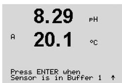
Coloque el electrodo en la primera solución amortiguadora y pulse la tecla [ENTER].
