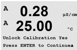
Si selecciona «Sí», podrán seleccionarse los menús de calibración del medidor en el menú «CAL». Si selecciona «No», en el menú «CAL» solo estará disponible la calibración de los sensores. Pulse [ENTER] tras la selección para que aparezca la pantalla de confirmación.
