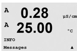
Si pulsa la tecla ▼, se visualizará el menú «Info» con las opciones «Mensajes», «Datos de Calibración» y «Model/Rev del Software».
