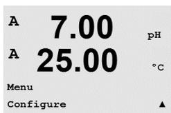
En el modo de medición, pulse la tecla ◀. Pulse la tecla ▲ o ▼ para navegar hasta el menú de configuración y pulse [ENTER].
