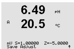
«Z» es el factor de calibración de desviación calculado de nuevo. El factor de calibración de pendiente «S» es siempre 1 y no entra en el cálculo.
