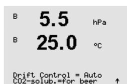
Para la calibración, seleccione «Control de deriva» como «Auto» (la calibración se finaliza de forma automática cuando se cumplen los criterios de deriva y de tiempo) o «Manual» (el usuario puede decidir cuándo una señal de CO<sub>2</sub> es lo suficientemente estable como para finalizar la calibración).
