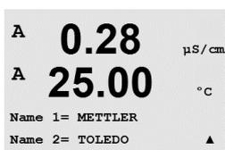
Utilice las teclas ◀ y ▶ para navegar entre los dígitos que van a modificarse. Utilice las teclas ▲ y ▼ para cambiar el carácter que va a visualizarse. Una vez que se hayan introducido todos los dígitos en ambos canales de la pantalla, pulse [ENTER] para abrir el cuadro de diálogo «Grabar cambios?».
