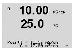
Introduzca el valor de conductividad de la muestra y, a continuación, pulse la tecla [ENTER] para iniciar el cálculo de los resultados de calibración.
