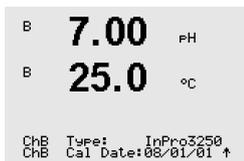
En este menú aparecerá la siguiente información sobre el sensor. Utilice las flechas de desplazamiento arriba y abajo para desplazarse en el menú. Tipo: tipo de sensor (p. ej., InPro 3250)
