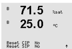
Si se conecta un sensor de oxígeno, aparece el menú para reiniciar el contador CIP y SIP. Ambos contadores deben reiniciarse después de las siguientes operaciones.
