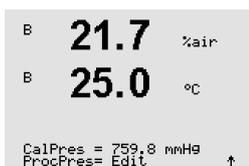
Introduzca la presión de calibración en la línea 3. El valor por defecto para «CalPres» es 759,8 y la unidad por defecto es mmHg.
