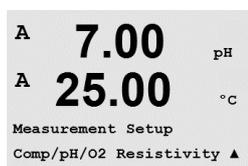
Según el sensor conectado, el menú pH, O<sub>2</sub>, CO<sub>2</sub> puede seleccionarse con la tecla ▲ o ▼. Pulse [ENTER].
