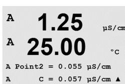
Introduzca el valor para el punto 1, incluido un decimal y la unidad. El valor de la segunda línea de texto es el valor que están midiendo el transmisor y el sensor en las unidades seleccionadas por el usuario. Cuando este valor se haya estabilizado, pulse [ENTER] y coloque el electrodo en la segunda solución de referencia.
