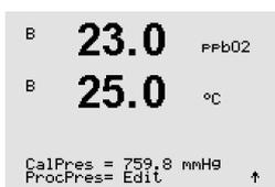
Introduzca la presión de calibración (línea 3). El valor por defecto para «CalPres» es 759,8 y la unidad por defecto es mmHg.
