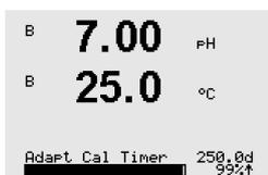
«Adapt D1152 Cal»: Este temporizador indica cuándo debe realizarse la siguiente calibración para mantener el mejor rendimiento de medición posible. El temporizador de calibración adaptable se indica en días (d) y porcentaje (%). Si desea consultar una descripción del temporizador de calibración adaptable, consulte la sección 8.4 «Configuración de ISM (disponible para sensores de pH y sensores de oxígeno y dióxido de carbono disuelto ISM)».
