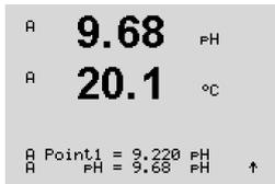
Introduzca el valor de pH de la muestra y, a continuación, pulse la tecla [ENTER] para iniciar el cálculo de los resultados de calibración.
