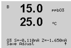
La pantalla cambia cuando se cumplen los criterios de estabilización. La pantalla muestra el resultado de la calibración correspondiente al valor «S» de pendiente y al valor «Z» de desviación.
