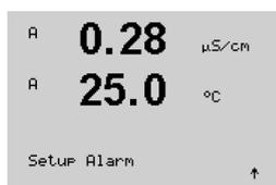
Este menú permite la configuración de las funciones de alarma de la pantalla. A través de la interfaz PROFIBUS PA puede conocer el estado de las alarmas proporcionado por el bloque de entrada separada. Si desea obtener más información al respecto, consulte el documento «Parámetros de PROFIBUS PA para el transmisor multiparamétrico M400 PA» en el sitio web <http://www.mt.com/m400-2wire>.
