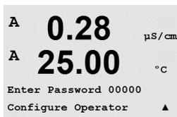
Elija «Sí» o «No» para permitir / denegar el acceso a los menús anteriores y pulse [ENTER] para avanzar a los siguientes elementos. Pulse la tecla [ENTER] después de ajustar todos los menús para abrir el cuadro de diálogo «Grabar cambios?». Seleccione «No» para desechar los valores introducidos y seleccione «Sí» para que los valores introducidos pasen a ser los valores actuales.
