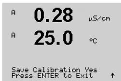
Una vez se hayan calibrado los puntos 1 y 2, vuelva a la pantalla «Calibrar Transmisor». Mueva el cursor para cambiar la resistencia 2 y designar el segundo intervalo de calibración. Siga con el proceso de calibración de dos puntos como hizo con el primer intervalo. Debe seguirse este mismo proceso para completar la calibración de la resistencia de los 5 intervalos.
