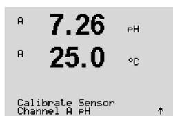
Seleccione calibración de «1 punto». Con los sensores de pH, la calibración de un punto siempre se realiza como calibración de desviación.
