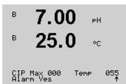
El límite de ciclo CIP cuenta el número de ciclos CIP. Si se alcanza el límite (definido por el usuario), se muestra una alarma en la pantalla. A través de la interfaz PROFIBUS PA puede conocer el límite del ciclo de autoclavización proporcionado por el bloque de entrada separada. La siguiente opción es posible:
