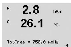
Si la unidad para el dióxido de carbono disuelto medido es %sat, es necesario considerar la presión durante la medición o la calibración. Para ello, ajuste el parámetro TotPres. Si se selecciona una unidad distinta a %sat, este parámetro no afectará al resultado.
