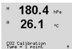
Seleccione «calibración de 1 punto». Con los sensores de CO<sub>2</sub>, la calibración de un punto siempre se realiza como calibración de desviación.
