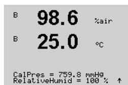
Ajuste la presión de calibración (PresCal) y la humedad relativa (Humedad Relativa) que se aplicarán durante la calibración. Pulse [ENTER].
