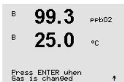
En cuanto se hayan cumplido los criterios de estabilización, la pantalla cambia y le indica que debe cambiar el gas.
