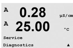
Este menú es una herramienta valiosa para la resolución de problemas y ofrece una función de diagnóstico para los siguientes elementos: Model/rev del software, Pantalla, Teclado, Memoria, Ver Ent Analógica y O<sub>2</sub> óptico.
