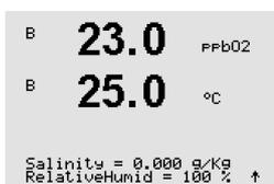
También puede introducirse la humedad relativa del gas de calibración. Los valores permitidos para la humedad relativa se encuentran entre el 0 y el 100 %. Cuando no está disponible la medición de humedad, use un 50 % (valor por defecto).
