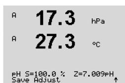
Seleccione Ajustar, Calibrar o Anular para terminar la calibración. Consulte el apartado 7.1.2 «Finalización de la calibración».
