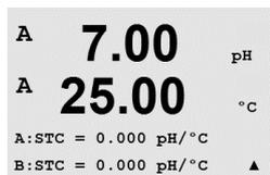
**FCT** es el coeficiente de temperatura de solución en las unidades de pH/°C que toman 25 °C como referencia (valor predeterminado = 0,000 para la mayoría de aplicaciones). Para agua pura, debe utilizarse un ajuste de 0,016 pH/°C. Para muestras de centrales eléctricas de baja conductividad cercanas a 9 pH, debe utilizarse un ajuste de 0,033 pH/°C. Estos coeficientes positivos compensan la influencia negativa de la temperatura en el pH de estas muestras. Pulse [ENTER].
