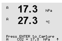
Introduzca el valor de CO<sub>2</sub> de la muestra y, a continuación, pulse la tecla [ENTER] para iniciar la calibración.
