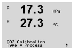
Obtenga una muestra y pulse la tecla [ENTER] de nuevo para guardar el valor de medición actual. A o B parpadea en la pantalla (en función del canal) y muestra el proceso de calibración en curso. Después de determinar el valor de CO<sub>2</sub> de la muestra, pulse la tecla ► de nuevo para continuar con la calibración.
