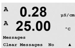
«Borrar Mensajes» elimina todos los mensajes. Los mensajes se añaden a la lista de mensajes cuando surge la condición que genera el mensaje. Si se borran todos los mensajes y sigue existiendo la condición que generó el mensaje, este no aparecerá en la lista. Para que vuelva a aparecer este mensaje en la lista, la condición debe desaparecer y reaparecer.
