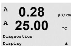
Todos los píxeles de la pantalla se encenderán durante 15 segundos para permitir la resolución de problemas de la pantalla. Tras 15 segundos, el transmisor regresará al modo de medición normal, o puede pulsar [ENTER] para salir antes.
