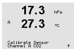
Seleccione «calibración de proceso». Con los sensores de CO<sub>2</sub>, la calibración de proceso siempre se realiza como calibración de desviación.
