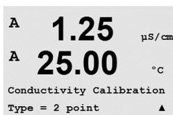
Seleccione «calibración de 2 puntos» y pulse [ENTER].
