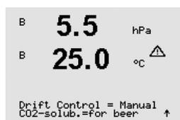
El sensor se suministra con una calibración y una configuración predeterminada de fábrica para el análisis de cerveza.
