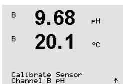
Entre en el modo de calibración de pH, como se describe en el apartado 7.1 «Entrar en el modo de calibración».
