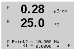
A continuación, la pantalla del transmisor solicitará al usuario que introduzca un valor para el punto 2 y mostrará el valor de medición de resistencia «R1». Cuando se estabilice este valor, pulse [ENTER] para realizar la calibración de este intervalo y mostrar una pantalla de confirmación.
