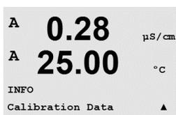
Si selecciona «Datos de Calibración», se mostrarán las constantes de calibración para cada sensor.
