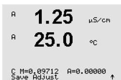
Después de la calibración de la celda, se visualizan el multiplicador o factor «M» de calibración de pendiente; es decir, la constante de celda, y el sumador o factor «A» de calibración de desviación.
