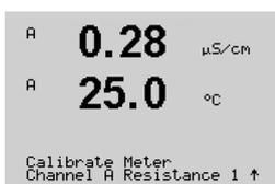
Navegue hasta la pantalla «Calibrar Transmisor» y seleccione «Canal A» o «Canal B» y «Resistencia 1», para indicar que el transmisor está listo para calibrar la resistencia de primer intervalo. Esta resistencia puede cambiarse seleccionando un intervalo entre 1 y 5. Cada intervalo de resistencia tiene una calibración de dos puntos.
