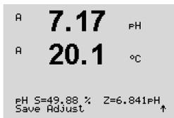
En cuanto se hayan cumplido los criterios de estabilización, la pantalla cambia para mostrar el factor «S» de calibración de pendiente y el factor «Z» de calibración de desviación.
