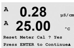
Pulse la tecla [ENTER] después de la selección para abrir la pantalla de confirmación. Si selecciona «No», regresará al modo de medición sin cambios. Si selecciona «Sí», se efectuará el reset de los factores de calibración del transmisor.
