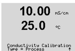
Seleccione «calibración de proceso» y pulse [ENTER]. Con los sensores de conductividad, la calibración de proceso siempre se realiza como calibración de pendiente.
