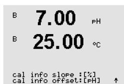
Pueden seleccionarse las unidades para la pendiente y el punto cero, las cuales se mostrarán en la pantalla. El ajuste predeterminado para la unidad de la pendiente es [%] y puede cambiarse a [pH/mV]. Para el punto cero, el ajuste predeterminado de la unidad es [pH] y puede cambiarse a [mV]. Utilice la tecla ► para ir al campo de entrada y seleccione la unidad con la tecla ▲ o ▼.
