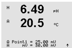
El usuario puede introducir ahora el punto 1. El factor de calibración de desviación se calcula con el valor del punto 1, en lugar del valor medido (línea 4, mV = ...) y se muestra en la pantalla siguiente.
