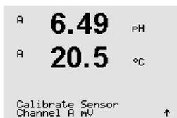
Entre en el modo de calibración mV, como se describe en el apartado 7.1 «Entrar en el modo de calibración».
