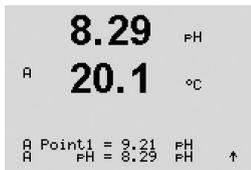
Coloque el electrodo en la solución amortiguadora. La pantalla muestra el tampón que ha reconocido el transmisor (punto 1) y el valor medido. Pulse [ENTER] para continuar.
