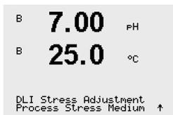
Ajuste el parámetro de estrés del proceso en función de la aplicación en concreto y / o los requisitos
