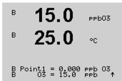
Introduzca el valor para el punto 1, incluido un decimal. El ozono es el valor que miden el transmisor y el sensor con las unidades configuradas por el usuario. Cuando este valor se haya estabilizado y se pueda llevar a cabo la calibración, pulse [ENTER].
