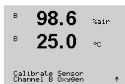
Entre en el modo de calibración de oxígeno como se describe en el apartado 7.1 «Entrar en el modo de calibración».
