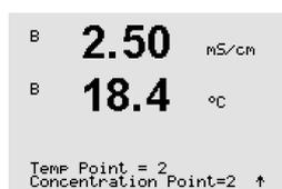
Introduzca la cantidad de puntos de temperatura deseados (**Temp Point**) y los puntos de concentración (**Concentration Points**).
