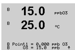
Introduzca el valor de O<sub>3</sub> de la muestra. Pulse la tecla [ENTER] para iniciar el cálculo de los resultados de calibración.
