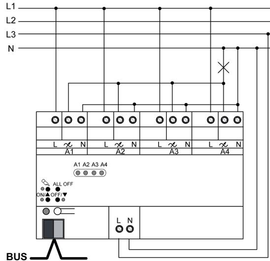
Imagen 5: Conexión paralela de salidas de regulador de luz; Ejemplo de conexión
