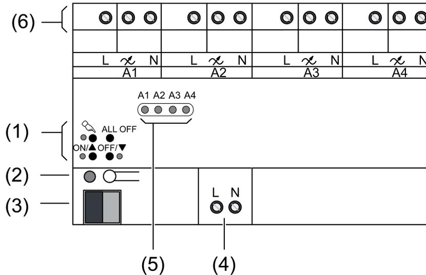
Imagen 2: Vista del actuador regulador de 4 elementos
