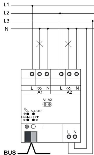
Imagen 4: Actuador de regulación – Ejemplo de conexión
