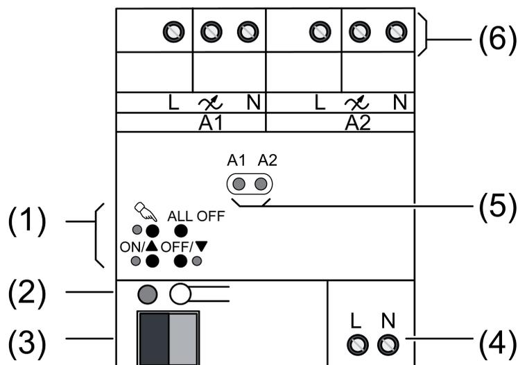
Imagen 1: Vista del actuador regulador de 2 elementos
