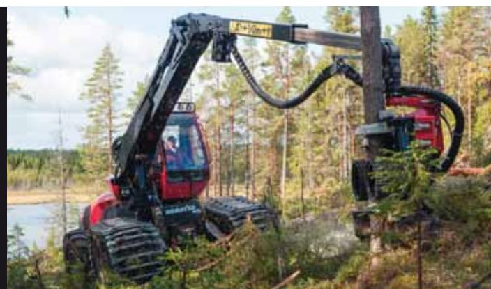
La exclusiva solución de la grúa situada en el centro de la máquina y la conexión de los cilindros de inclinación y el eje oscilante confiere una estabilidad superior.
