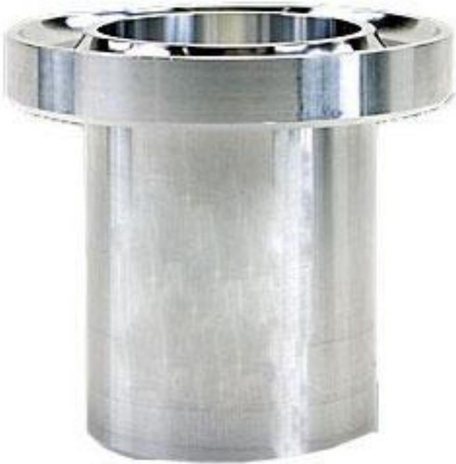
Cada copa Ford a sido producida conforma a las características de las copa de viscosidad catalogadas inicialmente en el boletín ASTM No. 169 de Octubre de 1950 y cumple con los requerimientos catalogados en ASTM D1200.
