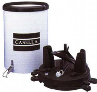
Figura 1. Pluviómetro de balancín con la protección retirada
