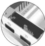
El puente de final de línea se encuentra ubicado en el conector CN3, situado en la parte posterior de la central.
