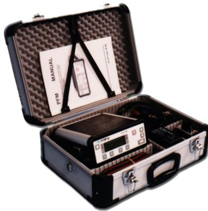
EQUIPO PORTÁTIL DE MEDICIÓN DEL CAUDAL Y DE LA
