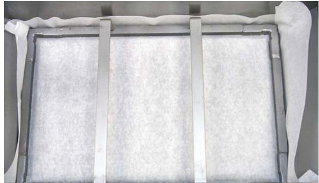
Aro de sujeción colocado correctamente sobre el papel filtro en la bandeja de filtro.
