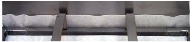
Asegúrese que el papel del filtro sobresalga dos pulgadas y que está distribuido de forma uniforme bajo el aro de sujeción.
