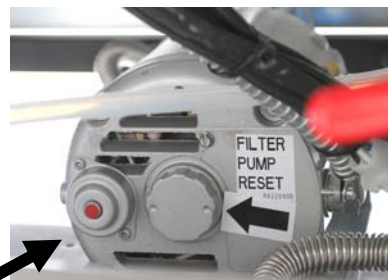
Interruptor de restablecimiento de la bomba del filtro
