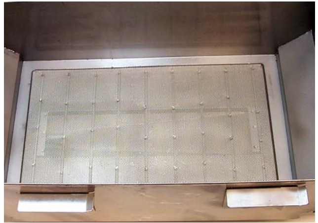
Rejilla de soporte colocada apropiadamente en la bandeja del filtro.
