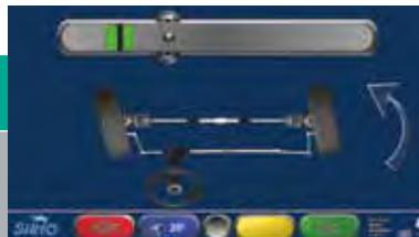
Procedura di sterzata realizzata elettronicamente tramite i sensori CCD per ottenere il valore di incidenza ed inclinazione del montante con elevata precisione.
