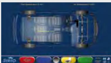
La diagnosi rapida del disassamento del telaio permette di evidenziare eventuali problemi di carrozzeria o di spostamento del retroreno.
