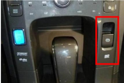
1. Accionar el freno de estacionamiento eléctrico
