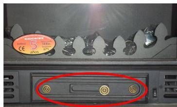
[1.2 ENTRADA DE AIRE SECUNDARIO / SECUNDARY AIR INLET / ENTRADA DE ARE SECUNDARIO / ENTREE D'AIR SECONDAIRE / PRESA D'ARIA SECONDARIA/ΕΙΣΟΔΟΣ ΤΟΥ ΔΕΥΤΕΡΕΥΟΝΤΑ ΑΕΡΑ.](#)
