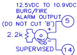
Conecte los equipos sonoros (sirenas electrónicas, eléctricas o mecánicas) a los terminales 5 (+) y 14 (-). Cualquier sirena electrónica que requiera 12VDC puede ser conectada. Cuando conecte sirenas mecánicas deberá supervisarlas mediante la colocación de una resistencia de 2.2k Ohm. **NOTA:** Vea en diagrama de conexiones las especificaciones sobre consumo, supervisión de sirena y relé de robo (burglary output relay).
