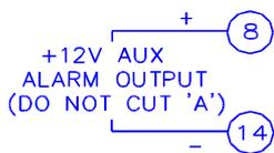
La salida auxiliar de alarma puede ser activada dependiendo de las opciones seleccionadas por programación (ver instrucciones de programación GEM-P9600). Conecte el equipo que desee activar entre los terminales 8 (+) y 14 (-). Si habilitamos la opción "Pulsos en salida auxiliar al conectar con mando" se puede conectar una sirena en estos terminales para este aviso de conexión y desconexión.
