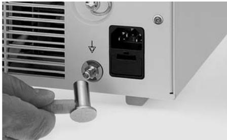
Das Gerät ist mit einer Steckvorrichtung für den Potentialausgleich ⑮ ausgerüstet. Lassen Sie die Erdung ggf. durch sachkundiges Personal durchführen.
