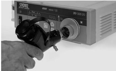
Den Anschlussstecker (Licht und Insufflation) des Videoendoskops bis zum Anschlag in die entsprechende Buchse ⑫ einstecken. Videoendoskop nur am Griffstück fassen. Niemals am Kabel ziehen.
