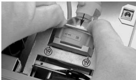
Drücken Sie die Lampenhalterung kräftig mit dem Zeigefinger der rechten und linken Hand ca. 2 mm gleichmäßig nach vorn (siehe Pfeilrichtung im Foto), bis sie sich aus der Verriegelung 19 löst. Ziehen Sie die Lampenhalterung unmittelbar nach dem Lösen aus der Verriegelung mit den beiden Zeigefingern etwas nach oben, damit sie nicht wieder durch die Federkraft in ihre Ausgangsposition zurückspringt.
