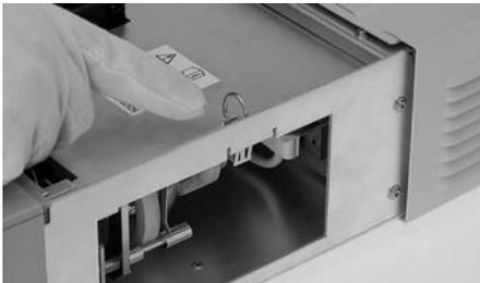
Lampendeckel herunterklappen und dadurch das Lampenfach verschließen. Dann mit Schnellverschluss sichern (90°-Drehung im Uhrzeigersinn).
