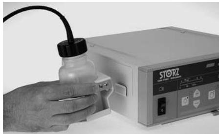
Wasserflasche für Spülung/Insufflation an XENON 100 SCB anbringen (siehe auch Gebrauchsanweisung Videoendoskop)
