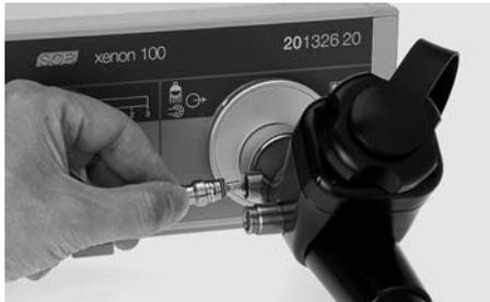
Den Schlauch von der Wasserflasche (im Deckel integriert) am Endoskopversorgungsstecker (Spülflaschenanschluss) anschließen.
