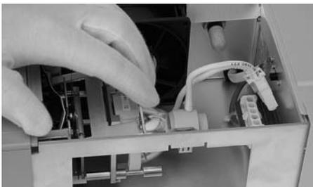
Die Lampenhalterung herunterdrücken, bis sie einrastet. Als Riegel ausgebildet, gleitet sie dabei vor und zurück. Unterstützen Sie ggf. diese Bewegung.
