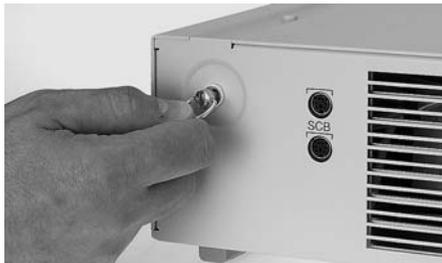
Gehäusehaube öffnen. Dazu die zwei Schnellverschlüsse an der Rückseite des Gerätes durch 90°-Drehung gegen den Uhrzeigersinn lösen.
