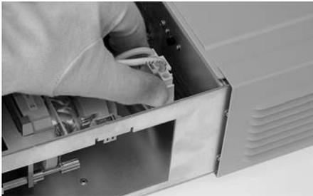
Lampenstecker in die dafür vorgesehene Buchse im Gerät einstecken (nur in einer Position möglich) bis die Haken einrasten.
