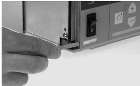
Den vormontierten „englischen“ Beschriftungsstreifen entfernen und den ausgewählten Beschriftungsstreifen zwischen Dekorfolie und Frontblech schieben.
