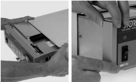
Die Geräteabdeckung zurückschieben (siehe auch den Abschnitt „Lampenwechsel“ auf Seite 22) und die links verriegelte Frontblende entfernen.
