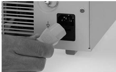
Netz Kabel anschließen, Netzstecker bis zum Anschlag in Netzbuchse ⑯ des Gerätes stecken.
