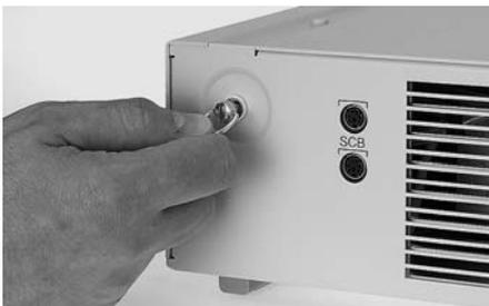
Gehäuse wieder schließen und mit Schnellverschluss sichern (90°-Drehung im Uhrzeigersinn). Alle Kabel wieder anschließen.
