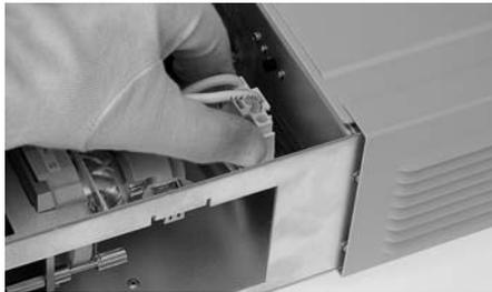
Verriegelung des Lampensteckers durch beidseitiges Drücken lösen und gleichzeitig Stecker gleichmäßig herausziehen.
