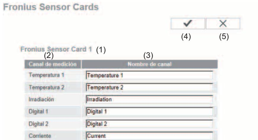
En "Sensor Cards" se puede asignar un nombre de canal específico por cada valor de sensor de una Fronius Sensor Card / Box (por ejemplo: velocidad del viento).
