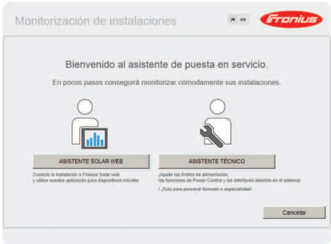
El asistente técnico está previsto para el instalador e incluye ajustes específicos según las normas. La ejecución del asistente técnico es opcional.
