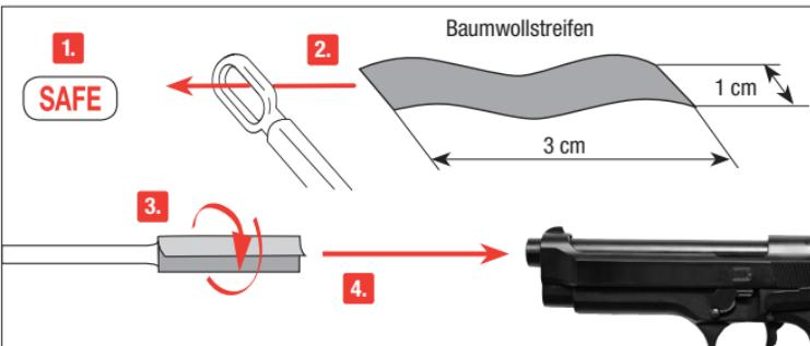
Sichern Sie die Waffe. Nehmen Sie einen ca. 30 cm dicken, langen Stab. Wickeln Sie ein Stück Baumwolltuch um das Ende, benetzen Sie das Tuch mit etwas Waffen-Öl und reinigen Sie damit den Lauf.
