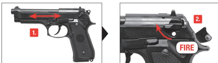
Para cargar el arma, tire de la palanca de armado hacia atrás hasta el tope y, a continuación, desplácela hacia adelante.
