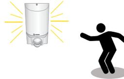
⚠ Cuando el sensor detecte movimiento la lámpara se encenderá y durará encendida el tiempo programado. La lámpara se apagará cuando no halla movimiento
