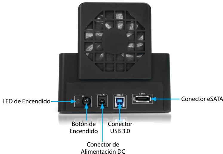
**NOTA:** Es posible utilizar como sustituto un cable USB 2.0, sin embargo la velocidad de conexión del dock será limitada a USB 2.0.
