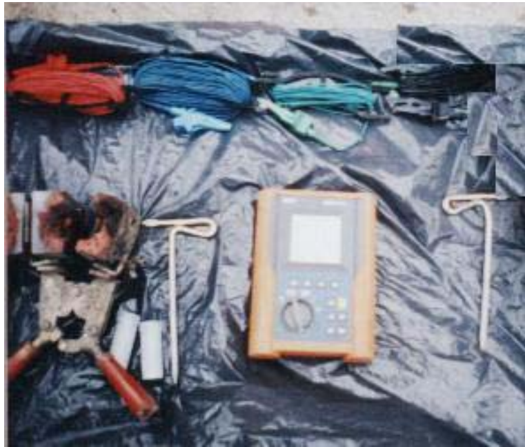
Figura 24. Telurómetro, molde de grafito y soldadora exotérmica
