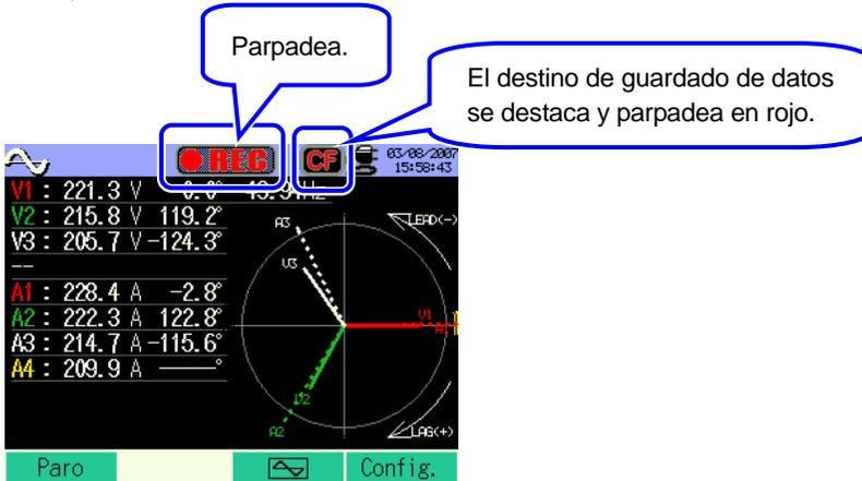
La configuración no puede modificarse durante el registro. Pulse la tecla **F4** para revisar la configuración.
