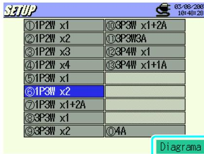
Pulse **F4** para mostrar el diagrama de conexión de la configuración seleccionada.
