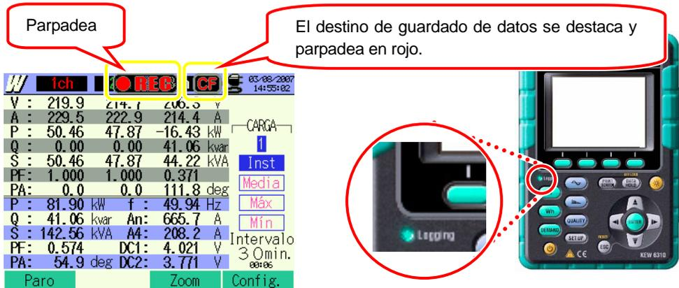
La configuración no puede modificarse durante el registro. Pulse la tecla **F4** para revisar la configuración.
