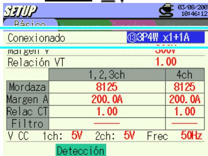
2 Pulse los **Cursores** ▲ ▼ ◀ ▶ para seleccionar la configuración de conexión adecuada y pulse la tecla **ENTER**.
