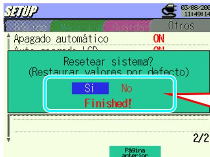
El reset del sistema se completa cuando el mensaje "Finished!" se muestra por pantalla.
