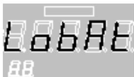
Tensión de alimentación débil. Controlar la batería de la tracción, las conexiones y la instalación eléctrica. Para controlar la tensión de entrada entrar en el menú del usuario correspondiente, como está ilustrado a continuación en este manual de instrucciones.
