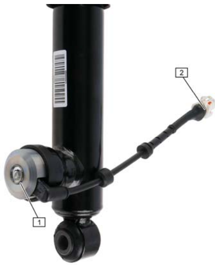
Fig. 8: 1 Proportional Dämpfventil / Variable proportional valve / Soupape d'amortissement proportionnelle / Válvula proporcional 2 Steckverbindung / Plug connection / Fiche de raccordement / Conector
