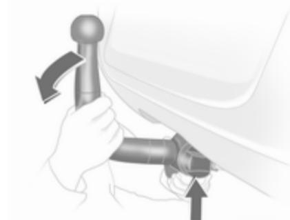
Inserte la barra de rótula tensada en la abertura y presione con fuerza hacia arriba, hasta que enclave de forma audible.
