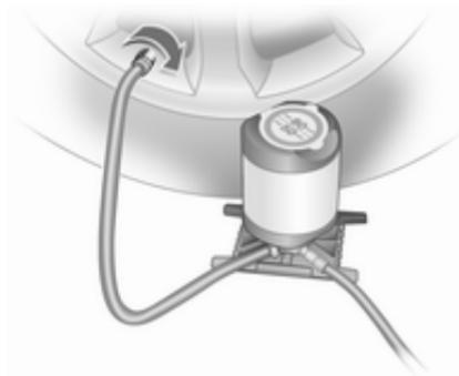
4. Desenrosque el tapón de la válvula del neumático averiado.
