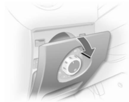
La caja de fusibles está detrás del conmutador de las luces. Tire del borde superior del panel y bájelo.
