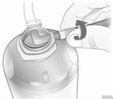
2. Desenrolle el tubo flexible del soporte y enrósquelo en la conexión del bote de sellador.
