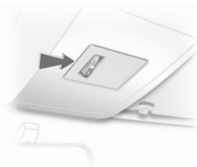
1. Desenclave el difusor con un destornillador en la posición indicada en la ilustración y desmóntelo.
