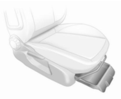
Levante por el rebaje del borde y extráigalo. Carga máxima: 1,5 kg. Para cerrarlo, presione y enclave.
