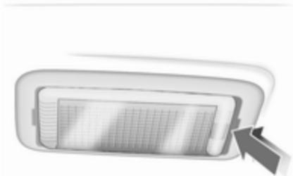
1. Extraiga la lámpara haciendo palanca con un destornillador.
