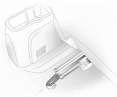
En el revestimiento del pilar en el techo trasero y en los puntos de fijación hay símbolos que indican las argollas donde montar el sistema de retención infantil.
