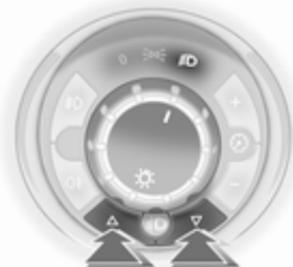
Para adaptar el alcance de los faros a la carga del vehículo y evitar el deslumbramiento: Pulse el botón  $\Delta$  o  $\nabla$  paso a paso hasta que aparezca el ajuste deseado en la pantalla del cuentakilómetros. La pantalla aparece durante 4 segundos cuando se conecta la luz de cruce o siempre que se cambia el alcance de las luces, junto con el símbolo  $\text{D}$ .
