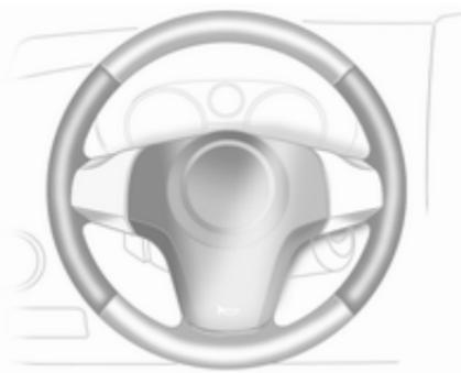
Con el motor en marcha, el volante se calienta en la zona mostrada en la ilustración superior.
