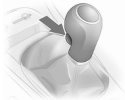
Para engranar la marcha atrás: con el vehículo parado, espere 3 segundos después de desembragar, apriete el botón de la palanca selectora y engrane la marcha.
