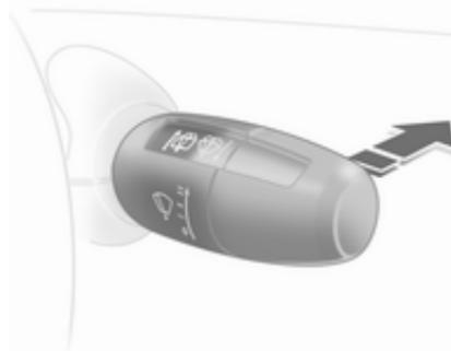
Presione la palanca hacia delante. El limpialuneta funciona a intervalos. Para desconectarlo, vuelva a presionar la palanca hacia delante.
