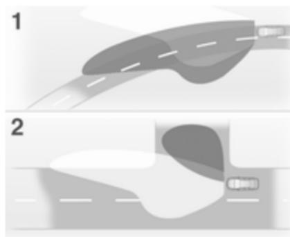
El haz de luz gira dependiendo de la posición del volante y de la velocidad.
