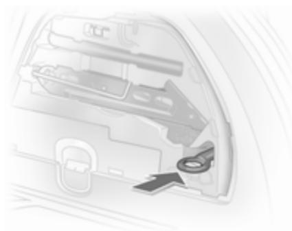
La argolla de remolque se guarda con las herramientas del vehículo ↻ 164. La argolla de remolque está situada en un rebaje.
