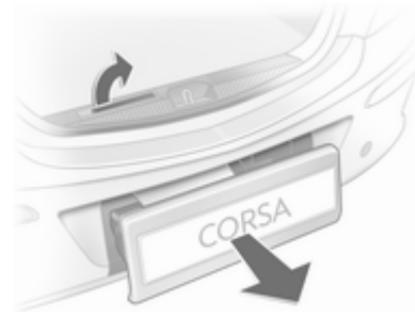
Levante la palanca de desbloqueo. El sistema se desenclava y sale rápidamente del parachoques.
