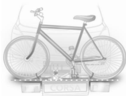
Ajuste los alojamientos para las ruedas de modo que la bicicleta quede en posición horizontal. La separación entre los pedales y el portón trasero debería ser de 5 cm (2 pulgadas) como mínimo.
