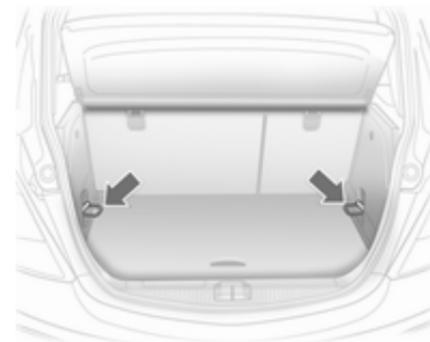
Las argollas están diseñadas para fijar las correas de amarre, o una red para el equipaje, y evitar que se desplacen los objetos transportados.
