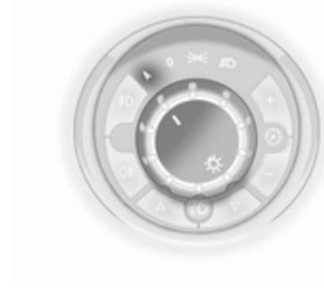
Conmutador de las luces en **A**: Con el motor en marcha, se conectan los faros en condiciones de poca luz exterior.
