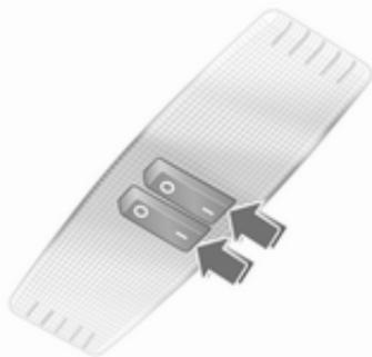
Se accionan con el interruptor (I = conectar, 0 = desconectar, posición central = modo automático).
