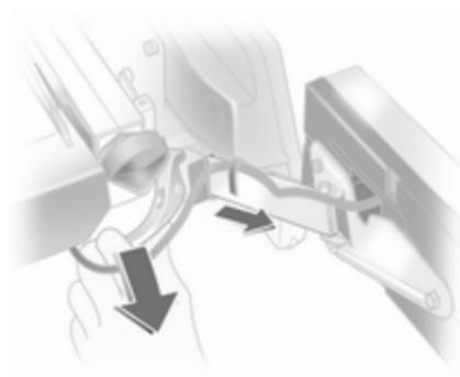
Baje la palanca de retención y extraiga los dos soportes de las luces de sus alojamientos.
