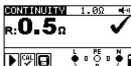
Figura 5.12: Ejemplo de medición de resistencia continua
