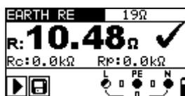
Figura 5.35: Ejemplo de resultado de medición de resistencia de tierra
