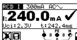
Figura 5.20: Ejemplo de resultados de medición de la corriente de disparo
