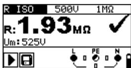
Figura 5.7: Ejemplo de resultado de medición de resistencia de aislamiento
