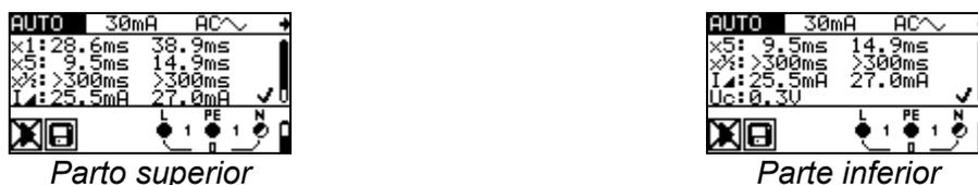
Figura 5.22: Dos partes del campo de resultados en autopruueba de RCD
