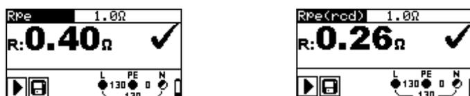
Figura 5.40: Ejemplo de resultado de medición de resistencia de conductor PE (tierra)
