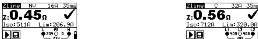
Figura 5.29: Ejemplo de resultado de medición de impedancia de línea
