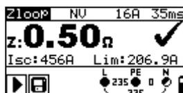
Figura 5.25: Ejemplo de resultados de medición de impedancia de bucle de defecto
