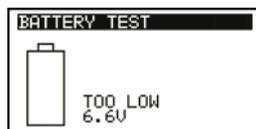
Figura 2.1: Indicación de pila descargada
