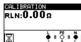
Figura 5.15: Resultados con valores de calibración antiguos.
