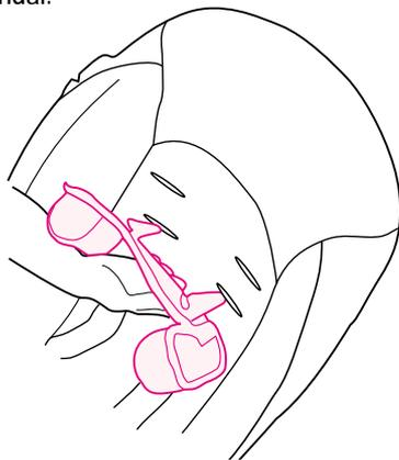
Coloque el soporte de la cabeza en el centro del asiento para el automóvil con los extremos orientados hacia abajo y trábelo en las ranuras del cinturón, por encima del arnés, como se muestra.
