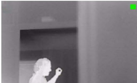
Figura 8.1 Imagen termal con Símbolo inminente de campo plano (cuadrado verde)
