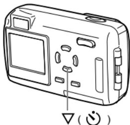
**4 Oriente el dispositivo de control remoto hacia el receptor de la cámara de la señal de control remoto.**
