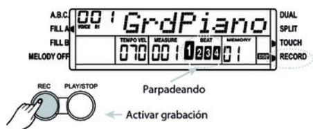
1. ▶ Pulse la tecla de [RECORD] para cambiar al modo de grabación. El display muestra el valor de "RECORD". Los indicadores de "BEAT 1" a "BEAT 4" aparecen parpadeando, señalizando así el estado de listo para grabar.
