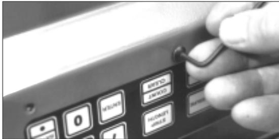
5. Deje el módulo plano, retire los cuatro tornillos de la parte posterior de la CPU y levante la tapa.
