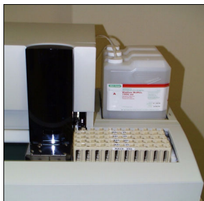
Figura 3-5 Colocación de gradillas en la VSS
