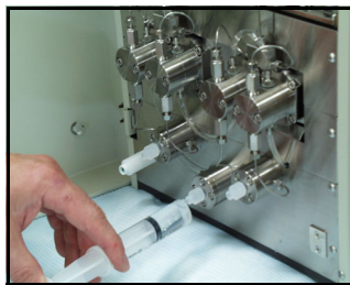
Figura 3-17 Limpieza de la conexión de lavado del pistón/junta (para instrumentos con nº de serie 11131 e inferiores)
