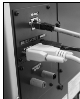
Figura 3-8 Terminal del sensor de residuos de la Estación cromatográfica (VCS)
