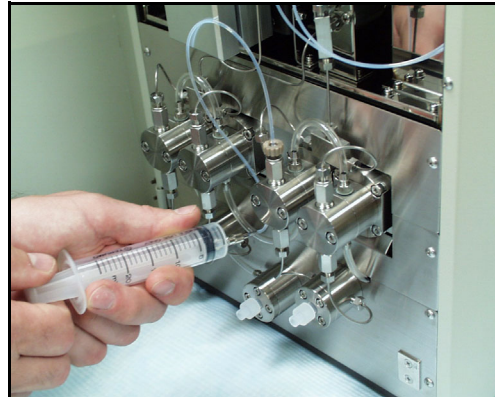
Figura 3-20 Extracción de la solución tampón de la primera válvula de retención de salida, bomba B
