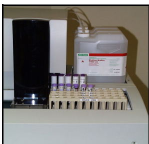
Figura 4-2 Colocación de gradillas
