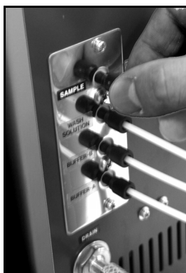
Figura 3-11 Conexiones de tubos de la Estación cromatográfica (VCS)
