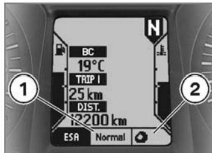
Con ayuda del electrónico del tren de rodaje ESA es posible adaptar el vehículo de forma cómoda a las diferentes condiciones de la marcha. Es posible combinar tres pretensados de los muelles con tres ajustes de amortiguación para lograr una adaptación óptima de la carga al piso. El ajuste de la amortiguación se indica en la pantalla multifunción, en
