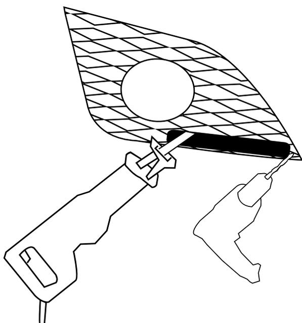
A continuación corta el plástico por la marca que has realizado y marca los agujeros para los tornillos.
