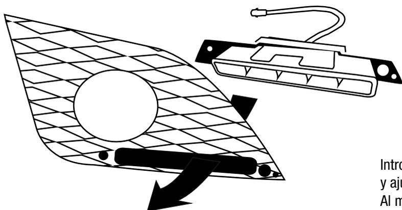
Introdúcelas por la parte posterior del frontal del vehículo y ajústalas al hueco que previamente has dejado. Al mismo tiempo coloca la pieza B por la parte delantera.
