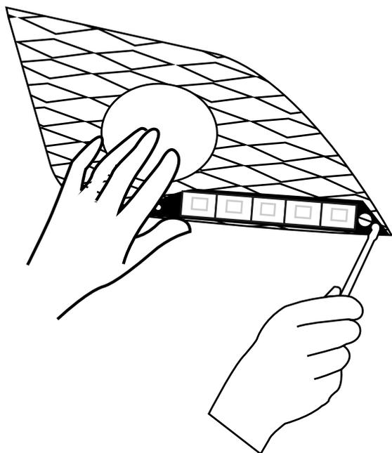
Procede a la colocación de los tornillos para que todo el conjunto quede ajustado.
