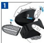
Για να συναρμολογήσετε τη βάση κουπών και τον δίσκο αποστράγγισης: αφαιρέστε το πλέγμα, τοποθετήστε τα δύο τμήματα το ένα δίπλα στο άλλο, κι έπειτα συνδέστε τον δίσκο αποστράγγισης με τη βάση κουπών.
