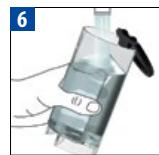
Rincez le réservoir d'eau avant de le remplir d'eau potable.
