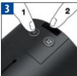
Halten Sie die Espressotaste gedrückt und schalten Sie die Maschine ein. Warten Sie, bis kein Wasser mehr herausfließt.
