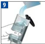
Znovu napiňte zásobník na vodu odvápnovacím roztokem z nádoby a zapoujte krok 8.
