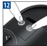
Para salir del modo de descalcificación, pulse los dos botones simultáneamente durante 1 segundo. La máquina está preparada para su uso.
