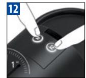
Aby wyjść z trybu odkamieniania, wcisnąć jednocześnie oba przyciski na jedną sekundę. Urządzenie jest gotowe do użytku.
