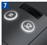
Drücken Sie die Espresso- (40 ml) oder Lungotaste (110 ml). Die Zubereitung stoppt automatisch. Um den Wasserfluss zu stoppen oder um Kaffee aufzufüllen, drücken Sie die Taste nochmals.
