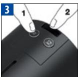
Przytrzymać i przytrzymać przycisk Espresso i włączyć urządzenie. Począć do całkowitego usunięcia wody.
