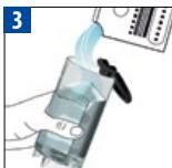
Llene el depósito de agua con medio litro de agua y añada el líquido de descalcificación Nespresso.
