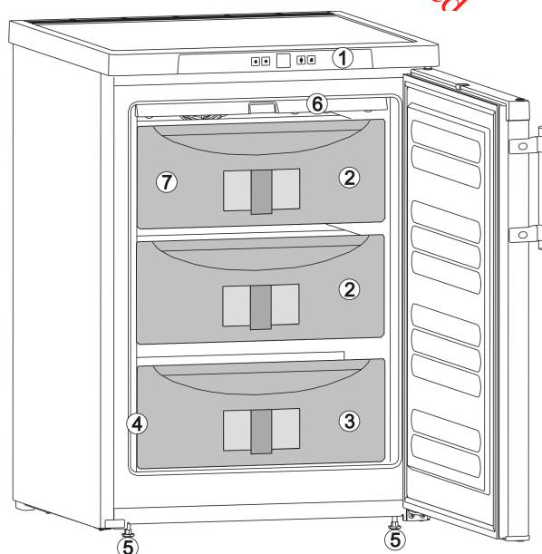
Fig. 1 (1) Éléments de commande et de contrôle (2) VarioSpace (3) Tiroir (4) Plaque signalétique (5) Pieds réglables (6) Dispositif NoFrost (7) Accumulateurs de froid
