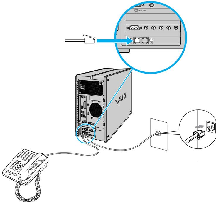
*Para conectar los cables de teléfono y del módem (modelo serie PCV-RS)*
