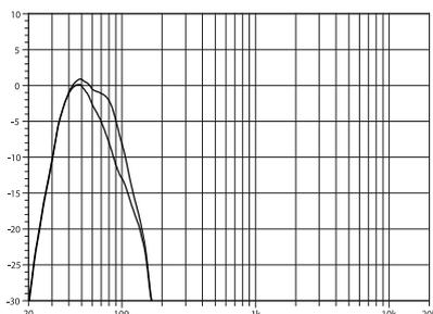
**Fig. 6: Respuesta de frecuencia de B2-SUB, estándar y modo INFRA**
