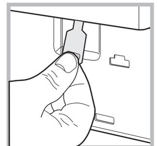
4. utilizando la lengüeta indicada en la figura, tire hacia fuera hasta liberar la varilla de plástico del retén; posteriormente tire hacia abajo y simultáneamente abra la puerta.
