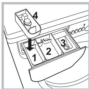
Esta función es útil para eliminar las manchas más resistentes. Introduzca la cubeta adicional 4 suministrada con el aparato, en la cubeta 1. Al verter el blanqueador no debe superar el nivel "máx." indicado en el perno central (véase la figura).
