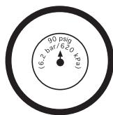
psig (6.2 bar), utilizando una manguera de aire con un diámetro de 9.5 mm.
