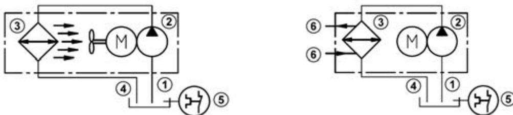
Figura 15: Esquema hidráulico de reductor industrial con sistemas de refrigeración CS1 y CS2
