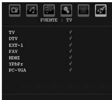
**Nota:** Sólo podrá utilizar el modo YPbPr cuando conecte un dispositivo que cuente con salida en formato YPbPr a través de la toma de entrada para PC utilizando un cable conversor de YPbPr a PC.
