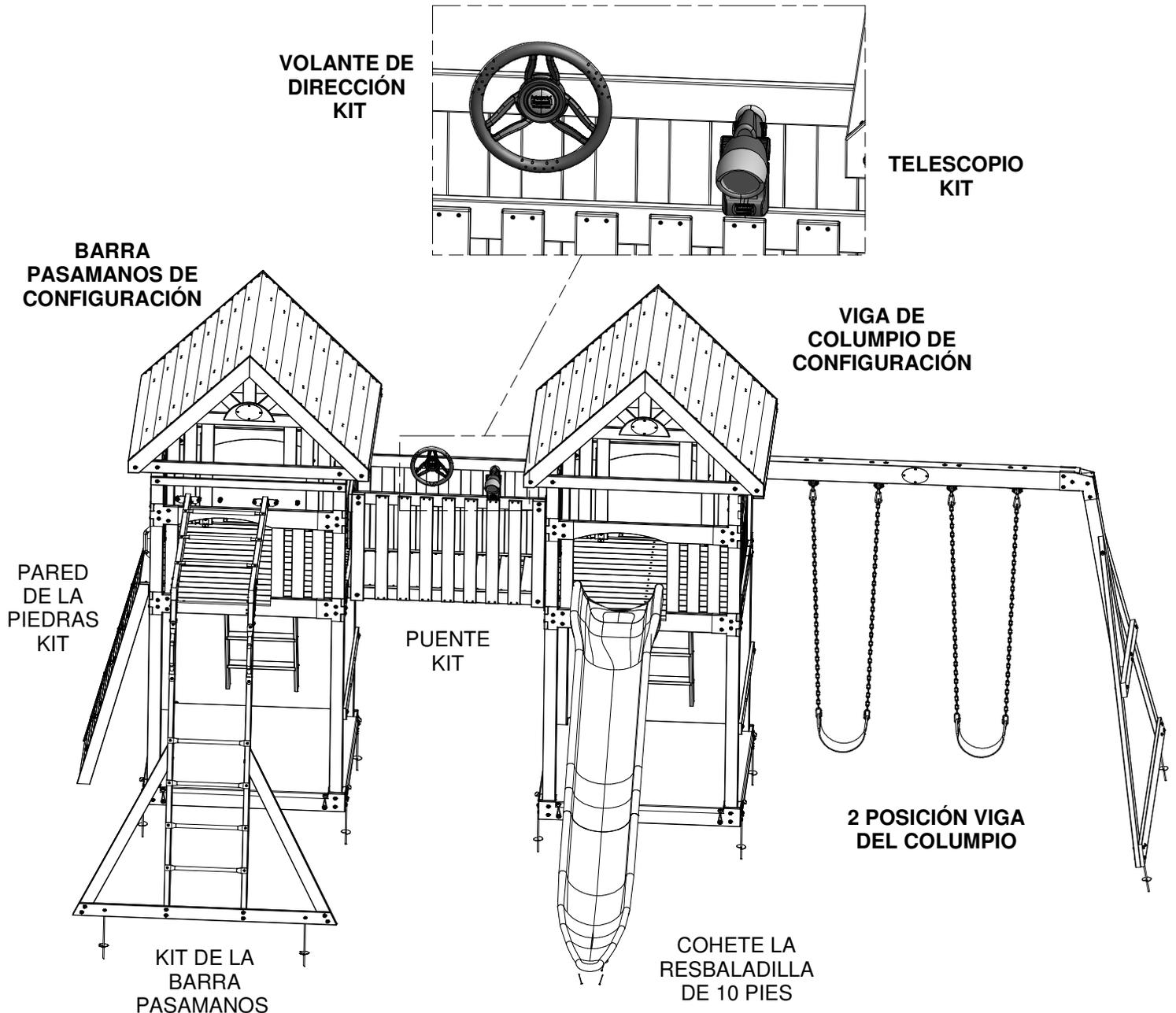
• SU "VOLANTE DE DIRECCIÓN Y TELESCOPIO KITS" DEBERÍA TENER ESTE ASPECTO ILUSTRACIÓN CUANDO HAYA TERMINADO.
