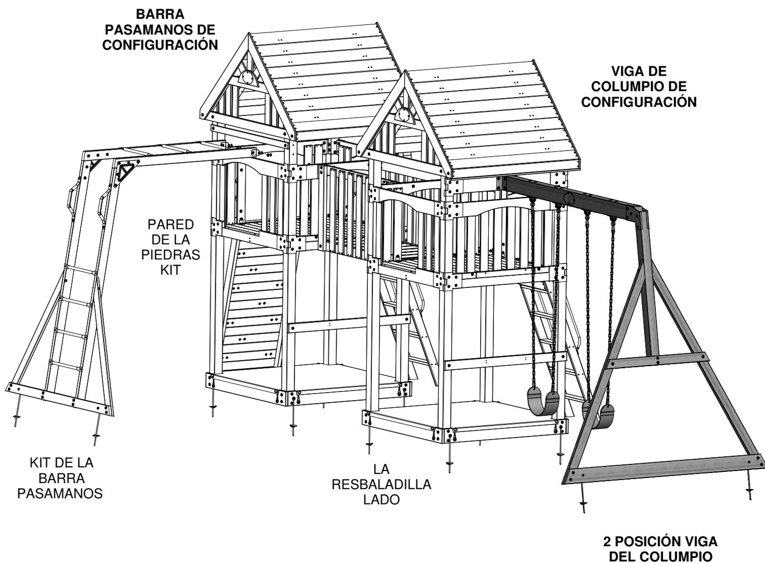
• SU "2 POSICIÓN VIGA DEL COLUMPIO" DEBERÍA TENER ESTE ASPECTO ILUSTRACIÓN CUANDO HAYA TERMINADO.
