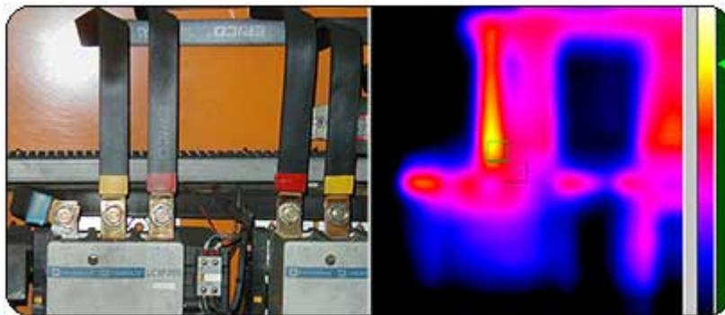
La TMTI 300 se utiliza para inspeccionar las conexiones de cables. La temperatura de la conexión de un cable puede ser considerablemente más alta que las de los demás cables, lo que podría indicar problemas potenciales y se debería analizar más en profundidad.
