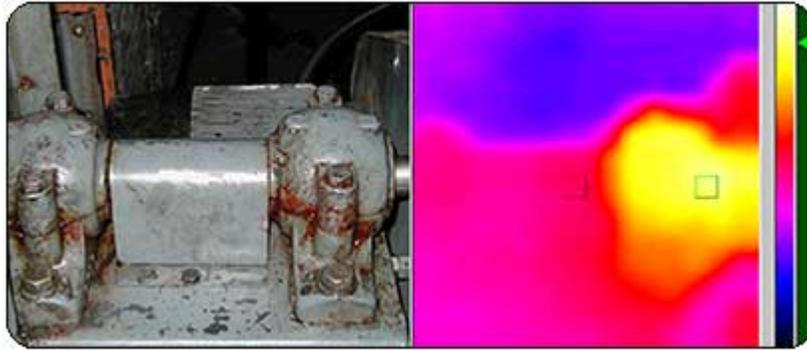
La TMTI 300 se utiliza para mostrar una diferencia de temperatura entre dos rodamientos en funcionamiento. Esta diferencia de temperatura podría indicar un problema potencial en los rodamientos que podría causar un fallo y una parada.
