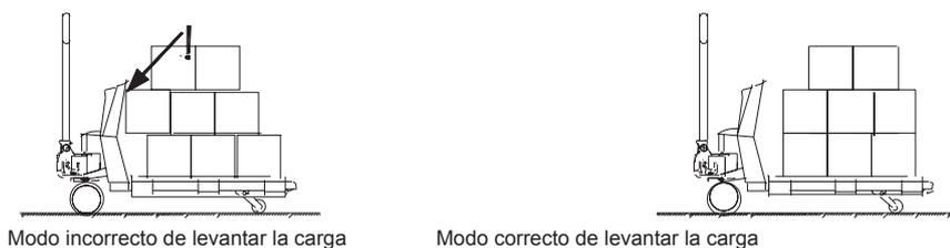
La carga a levantar tiene que ser dispuesta uniformemente para obtener una mayor seguridad de pesaje (pueden aparecer desviaciones hasta 0.8 % de la masa).
