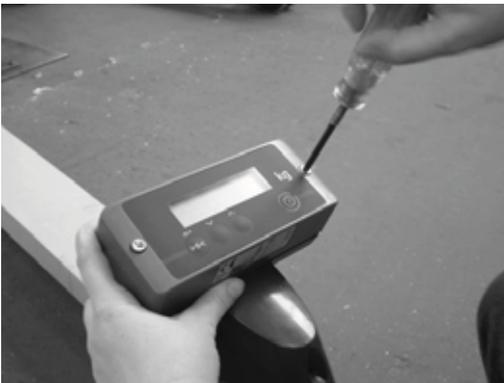
1. Aflojar los tornillos de fijación del display
