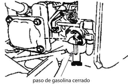
2.- Mover la palanca de control de velocidad al mínimo "L"
