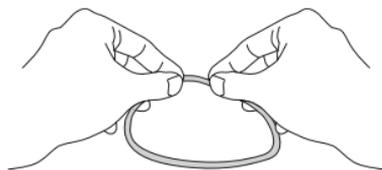
Extraiga las materias extrañas adheridas a la ranura de la junta tórica utilizando un paño limpio libre de hilazas o un palillo algodónado. Quite también toda arena y suciedad adherida a la superficie de contacto de la junta tórica, en la tapa delantera de la carcasa.
