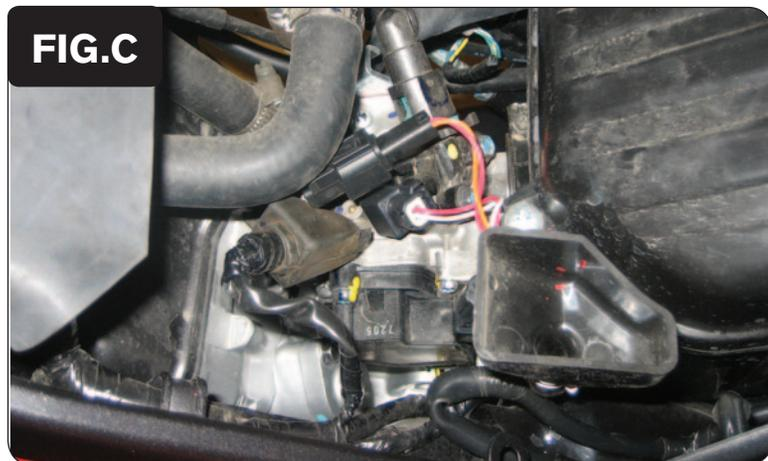
5. Conectar los conectores del PCV en línea con el mazo de cables de serie y el inyector (Fig. C).
