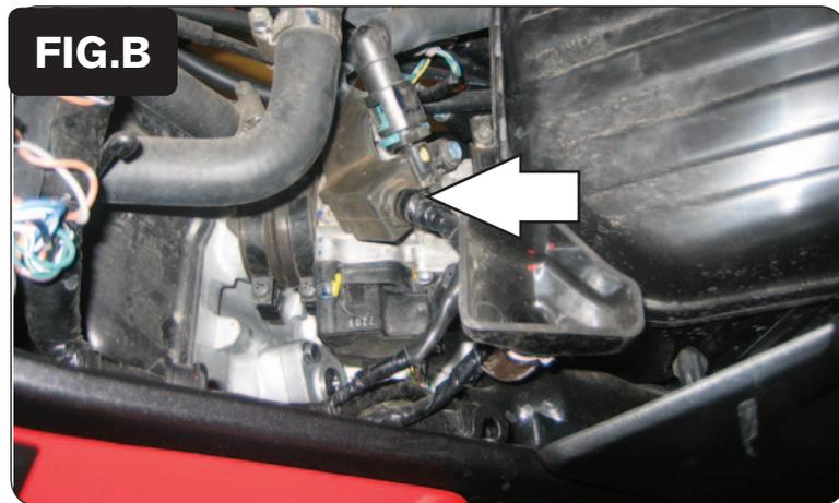
4. Desconectar el conector de serie del inyector de la moto. Este conector está protegido por un capuchón de goma (Fig. B).
