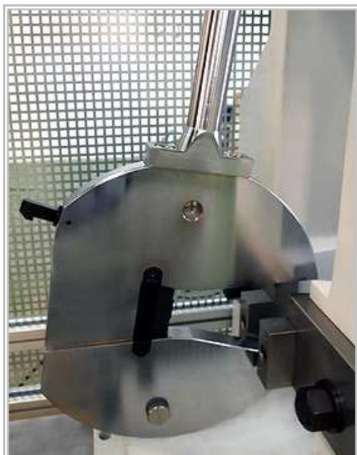
Esquema zona de colocación probeta de ensayo
