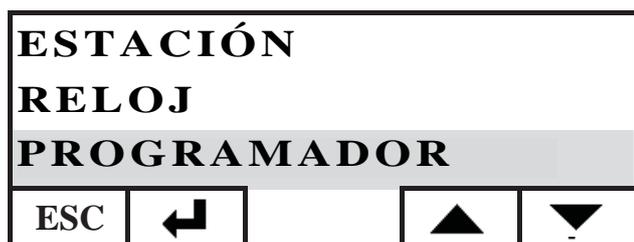
Activar el programador configurando la primera línea de selección de estado en ON. El programador se proporciona desactivado (OFF).
