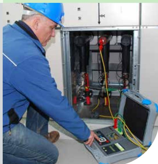
EL MI 3210 TeraOhmXA 10 kV es un instrumento portátil, alimentado por batería o desde la red con un excelente grado de protección IP (IP 65), destinado para el diagnóstico de resistencia de aislamiento usando alta tensión de prueba DC hasta 10 kV. Debido a su robustez (protección CAT IV) y una alta inmunidad a campos de RF irradiadas. Es el más adecuado para uso industrial.
