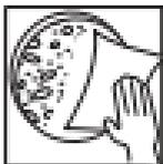
Reinigen Sie die Linsen (Okulare und/oder Objektive) nur mit dem beiliegenden Linsenputztuch oder mit einem anderen
